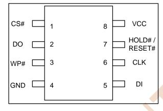
Figure 3.1 SOP8 (150/208mil)/ DIP8 (300mil)
