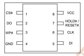
Figure 3.1 SOP8 (150/208mil)/ DIP8 (300mil)
