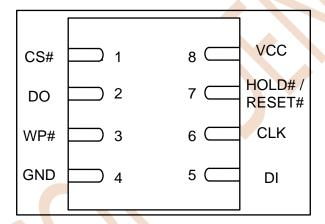
Figure 3.2 DFN8 (5\*6 mm)
