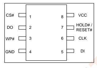
Figure 3.1 SOP8 (150/208mil)/ DIP8 (300mil)
